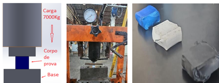
Figura 3 - Teste dos corpos de prova impressos: cubo (ensaio de compressão adaptado)
