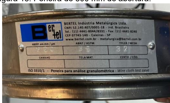
Figura 13: Peneira de 500 mm de abertura.
