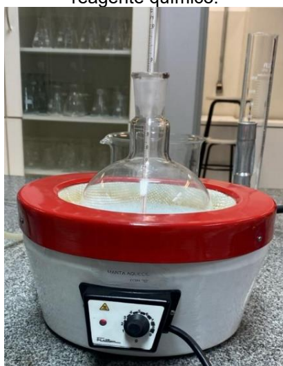
Figura 17: Teste do ponto de ebulição do reagente químico.
