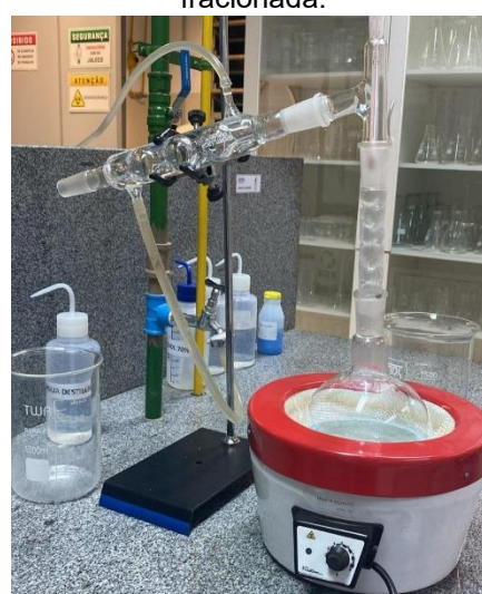
Figura 18: Montagem efetuada na destilação fracionada.
