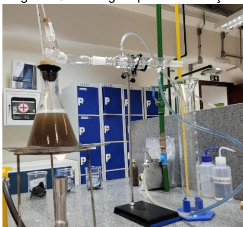
Figura 16: Montagem para a destilação.
