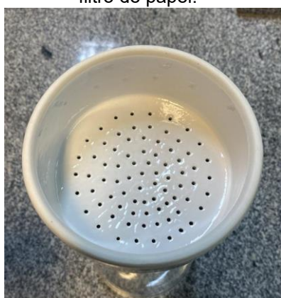
Figura 11: Funil adequado para utilização do filtro de papel.
