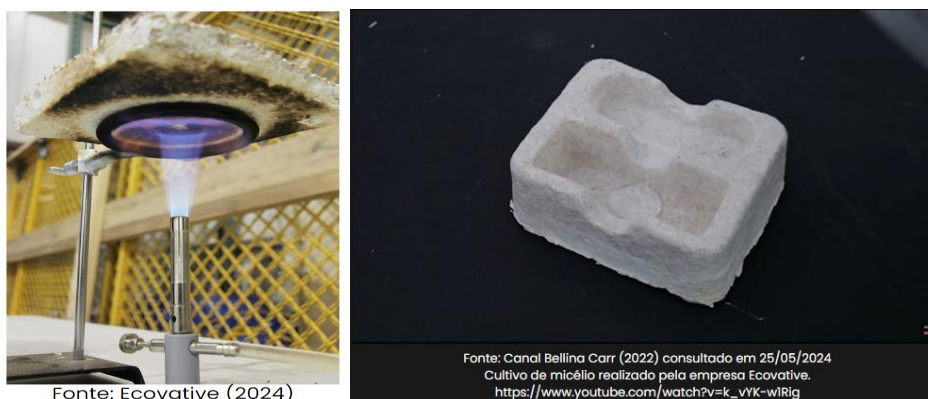
Figura 4 - Teste de micélio exposto ao fogo
