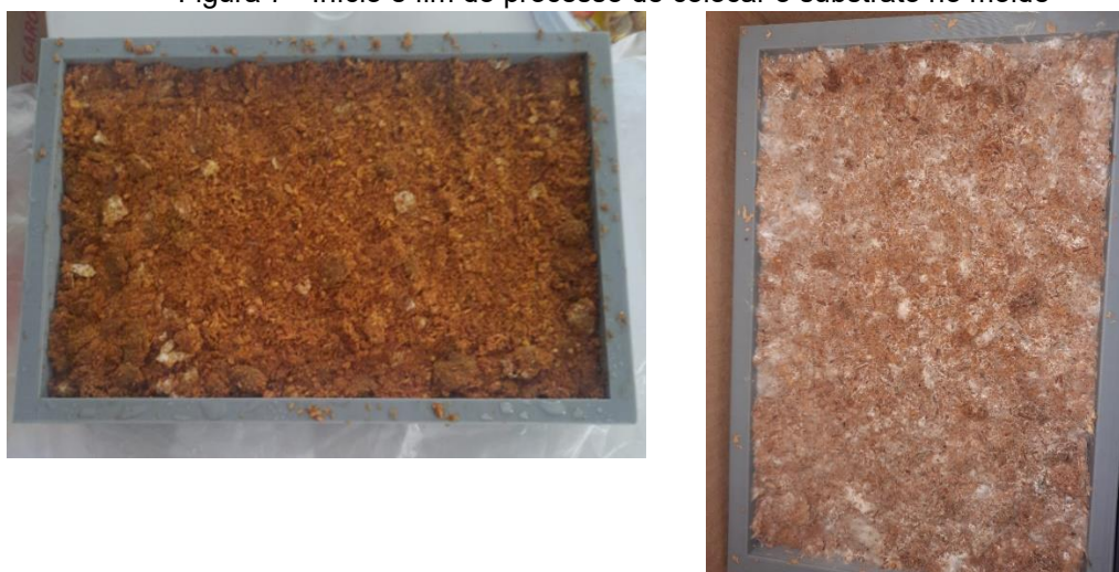
Figura 7 - Início e fim do processo de colocar o substrato no molde
