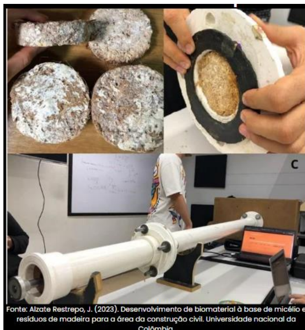
Figura 5 - Testes realizados com micélio em tubo de impedância
