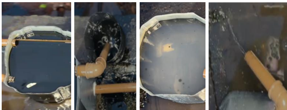
Figura 2 - Da esquerda para a direita: (a) entrada da mistura; (b) saída do óleo; (c) separação no recipiente; (d) saída da água
