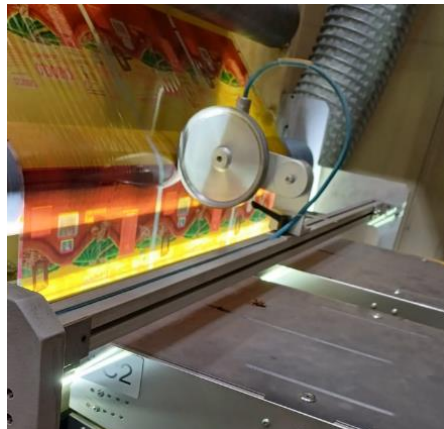
Figura 37 - Encoder instalado em máquina
