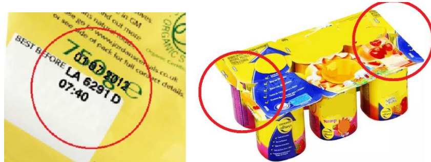
Figura 28 - Exemplos de defeitos ocasionados por variação de passo de fotocélula
