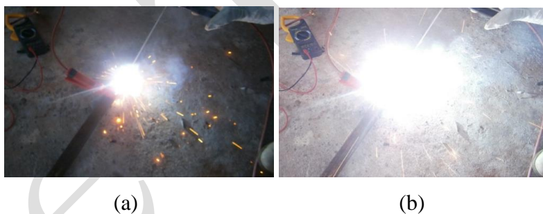
Figura 14 - a) Respingo de solda sem capacitor, b) respingos de solda com capacitor.
