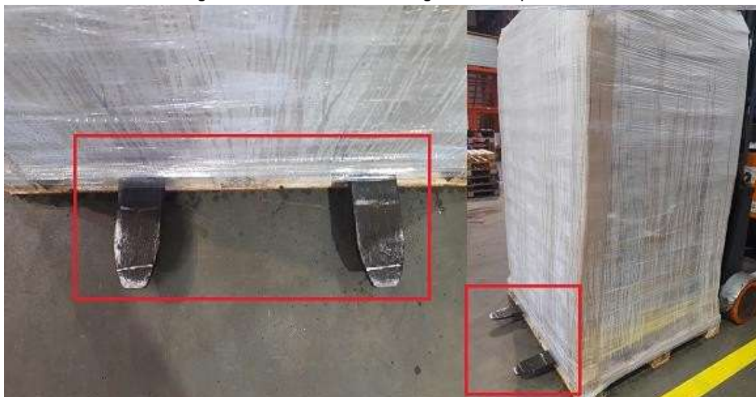
Figura 08 – Foto da sobra do garfo da empilhadeira
