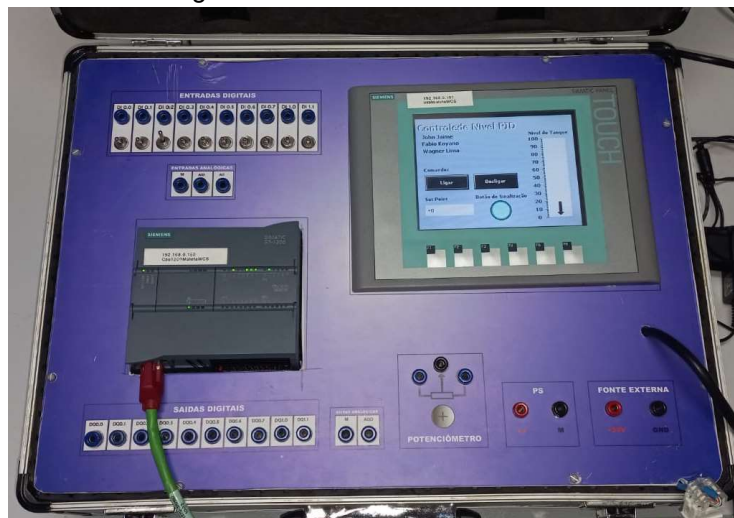
Figura 4 – IHM em Funcionamento
