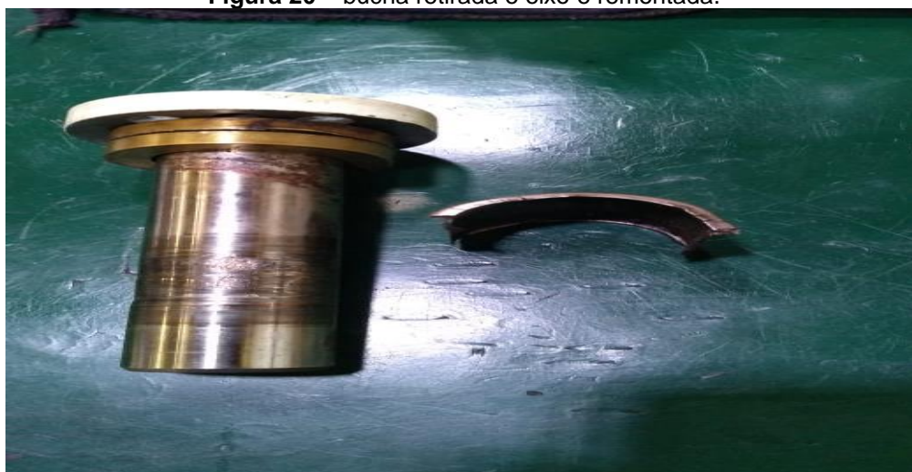
Figura 20 – bucha retirada e eixo e remontada.
