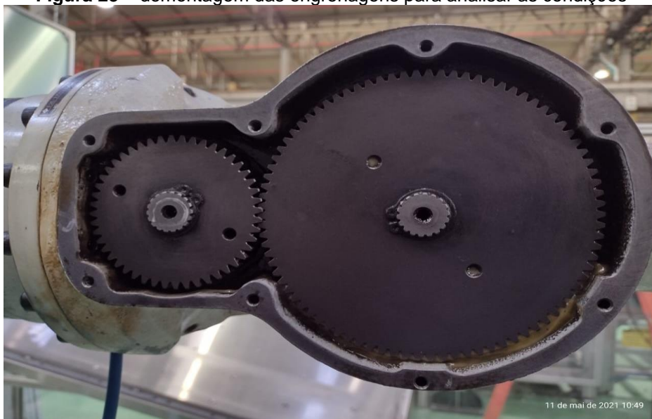
Figura 23 – demontagem das engrenagens para analisar as condições
