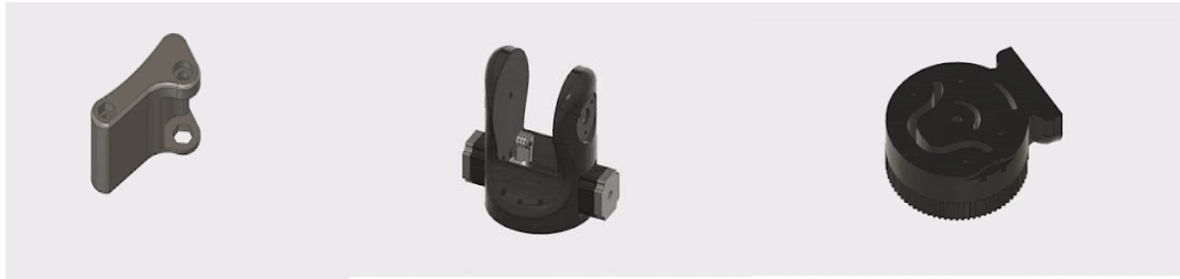
Figura 9 – Montagem da primeira articulação
