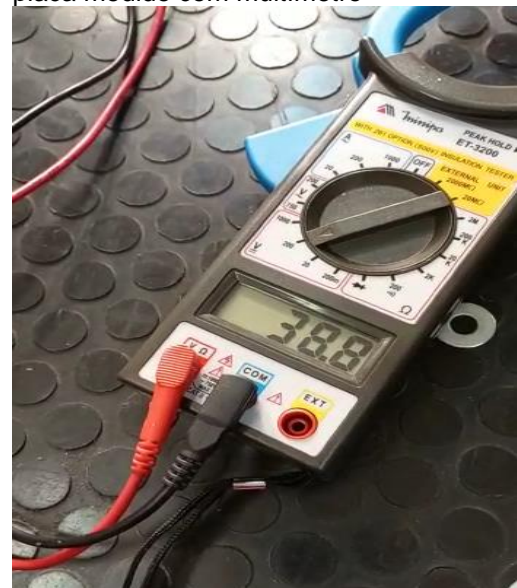
Figura 6 – Valor de Tensão gerada pela placa medido com multímetro
