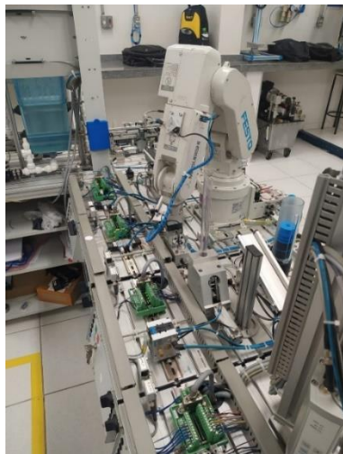
Figura 2 – Robô de paletização articulado
