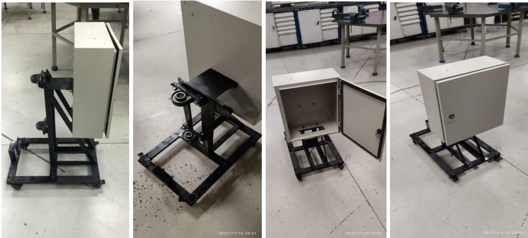
Figura 10 – Montagem mecânica do painel elétrico
