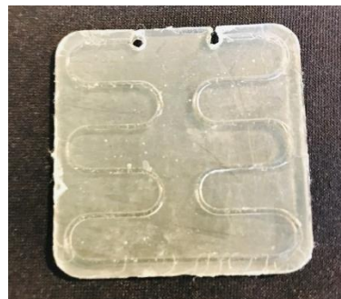
Figura 14 – Parte impressa em resina flexível do Sensor A.
