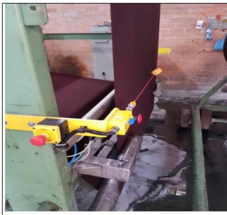
Figura 6: Sistema de parada de emergência.
