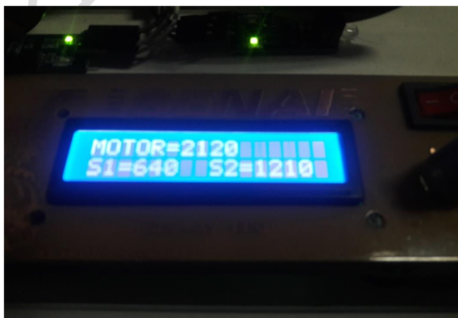
Figura 8:display mostrando as rotações do motor e das dois discos de saida (S1 e S2)
