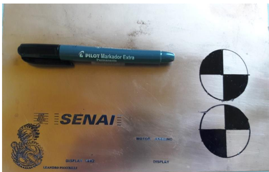
Figura 9: placa de fenolite após receber a transferencia da imagem
