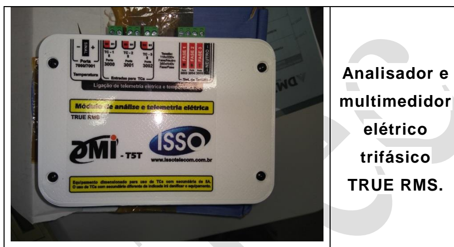
Quadro 6 – Analisador de energia
