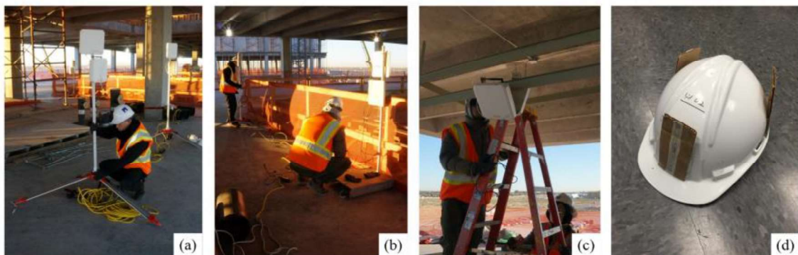
Figura 34 - (a) e (b) instalação de antena RFID para configuração de zona; (c) configuração da sala virtual; (d) etiquetas passivas montadas em um capacete de segurança.
