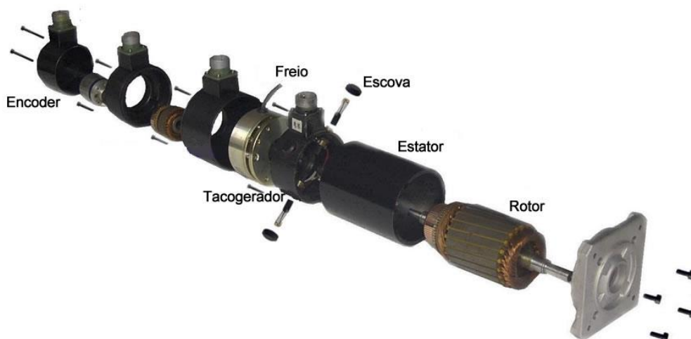
Figura 5, Servo Motor CC, Vista Explodida
