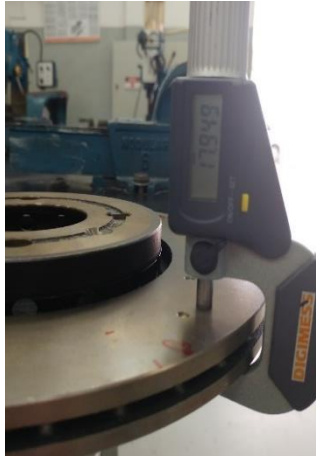
Figura 11 (a): Disco de freio novo
