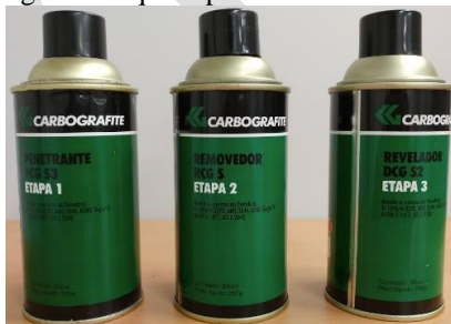
Figura 9-Líquido penetrante e revelador
