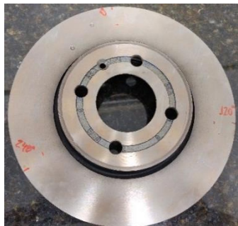
Figura 4 (a): Disco de freio novo
