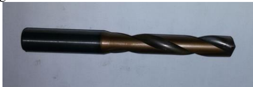
Figura 6 - Broca com revestimento utilizada.
