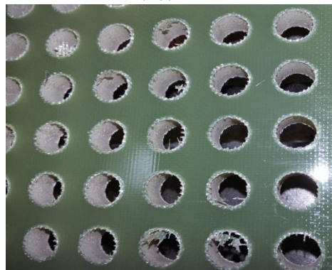
Figura 10(b): VC2 – Defeitos nos furos
