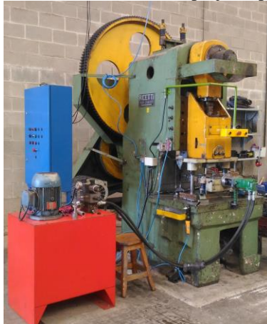
Figura 5: prensa excêntrica mecânica do projeto após a automação
