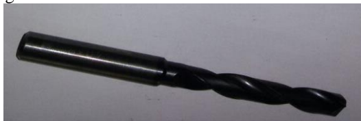
Figura 7 - Broca sem revestimento utilizada.
