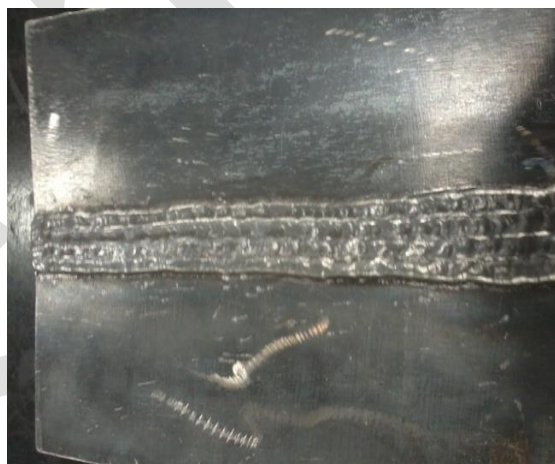
Figura 11-. Vista superior do corpo de prova soldado.
