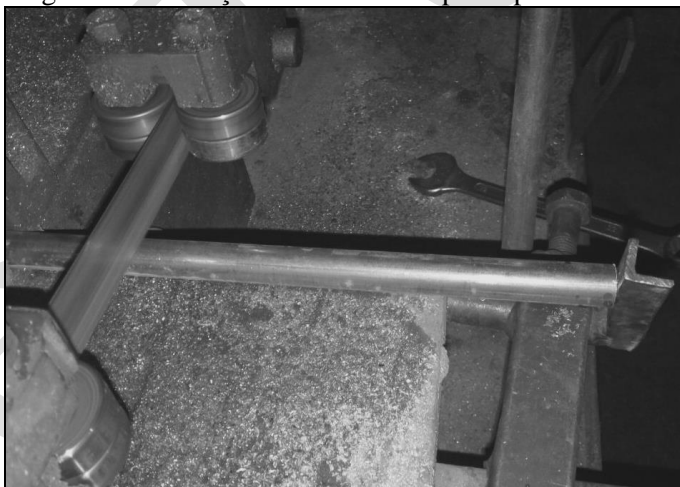
Figura 3 – Execução de corte do corpo de prova
