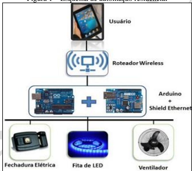
Figura 1 – Esquema de automação residencial
