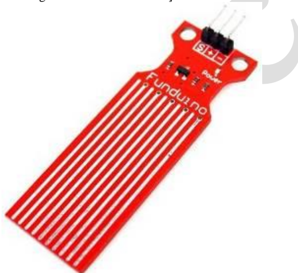
Figura 5 – Sensor de detecção de chuva
