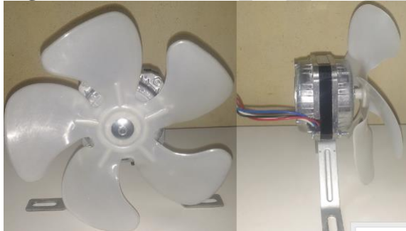
Figura 5: Motor ventilador do condensador
