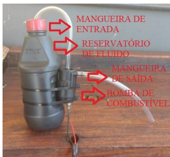
Figura 12. Dispositivo de aplicação do fluído (MQL).
