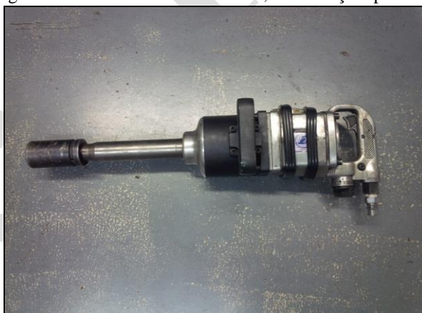
Figura 15 – Ferramenta de uso final, manutenção precária.
