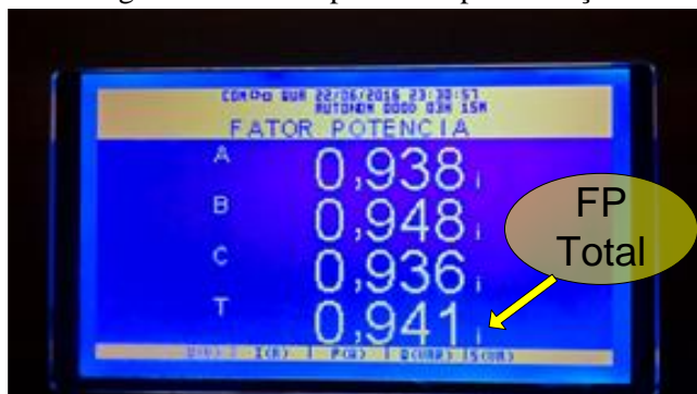
Figura 8: Fator de potência após correção
