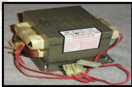
Figura 6 (a) - Transformador de micro-ondas em sua posição original, (b) Transformador já retirado.
