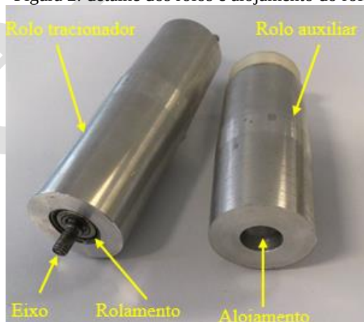
Figura 2: detalhe dos rolos e alojamento do rolamento
