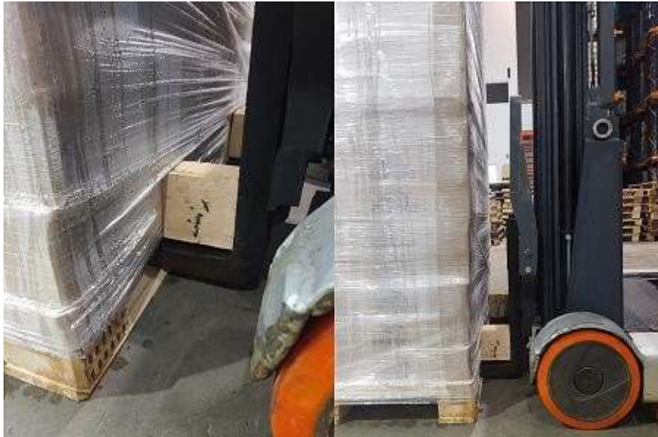
Figura 15 – Teste realizado com tarugo de madeira de 12cm
