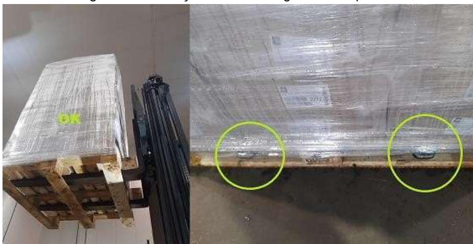
Figura 16 – Redução da sobra do garfo da empilhadeira
