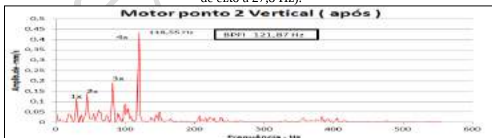
Figura 11 – Espectro em velocidade do motor (ponto V2 a 1666 RPM, frequência de eixo a 27,8 Hz).
