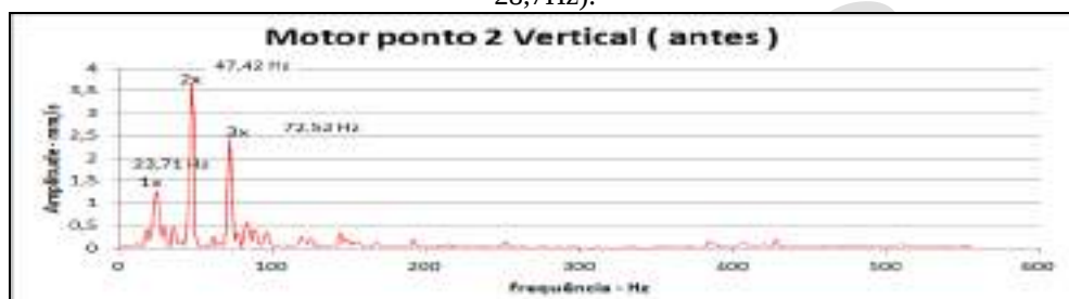
Figura 10- Espectro em Velocidade do motor (ponto V2 a 1720 RPM; frequência do eixo a 28,7Hz).
