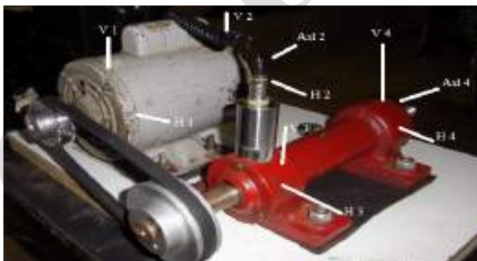
Figura 2 – Bancada didática: motor ½ CV acoplado a eixo de serra.
