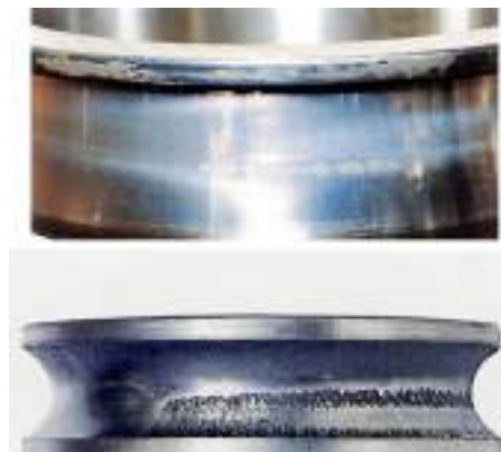
Figura 4- Danos na pista interna
