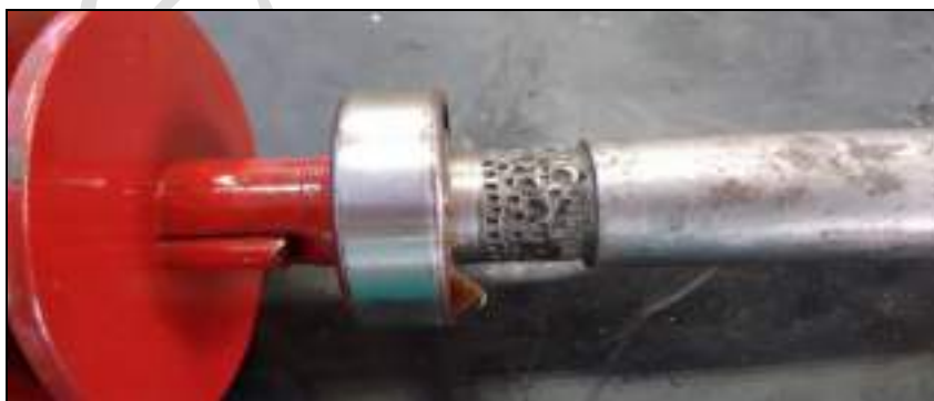
Figura 18 - Ajuste forçado para fixação do eixo, ponto 3.
