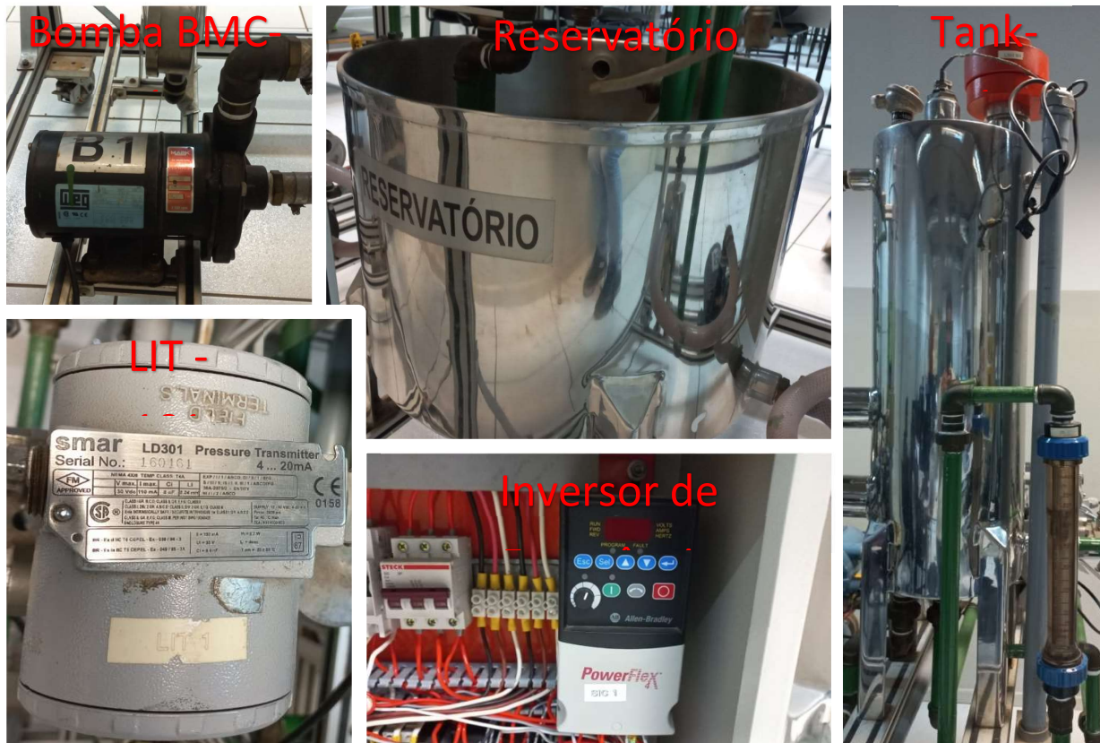
Figura 5 – Bancada Utilizada para Aplicação do Controle PI
