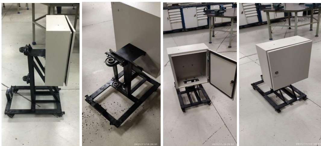
Figura 10 – Montagem mecânica do painel elétrico
