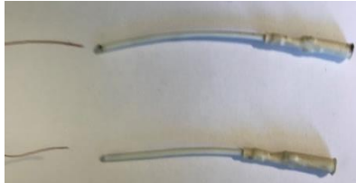
Figura 15 - Pontas dos eletrodos a serem reaproveitados e pontas do fio de cobre.
