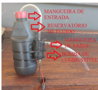
Figura 12. Dispositivo de aplicação do fluído (MQL).
