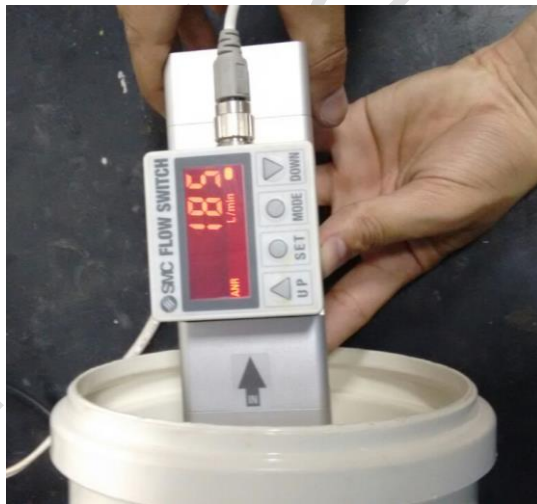
Figura 5- Medição de vazão do ar
