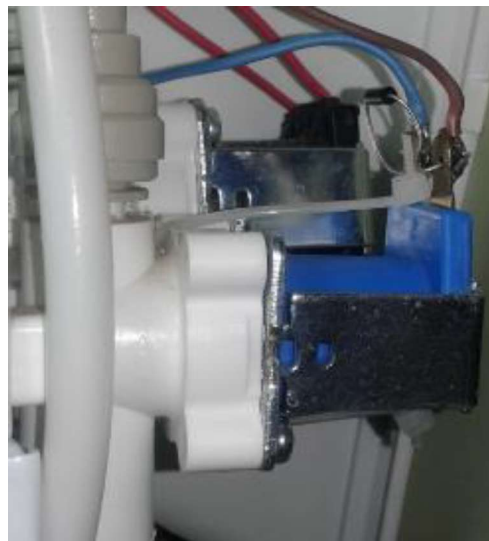
Figura 14-Valvula com diodo 1N4007
