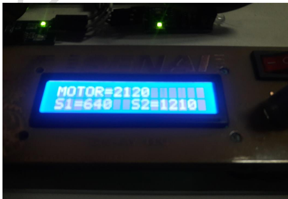
Figura 8:display mostrando as rotações do motor e das dois discos de saída (S1 e S2)
