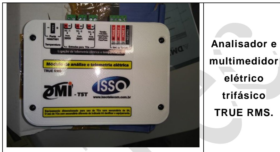
Quadro 6 – Analisador de energia
