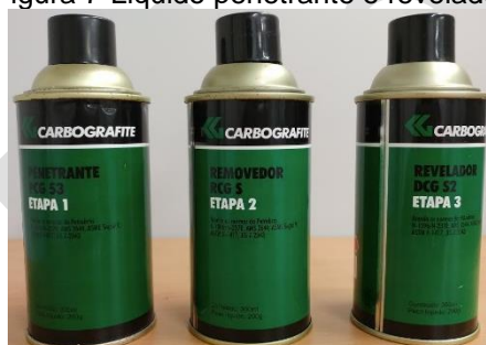
Figura 7-Líquido penetrante e revelador
