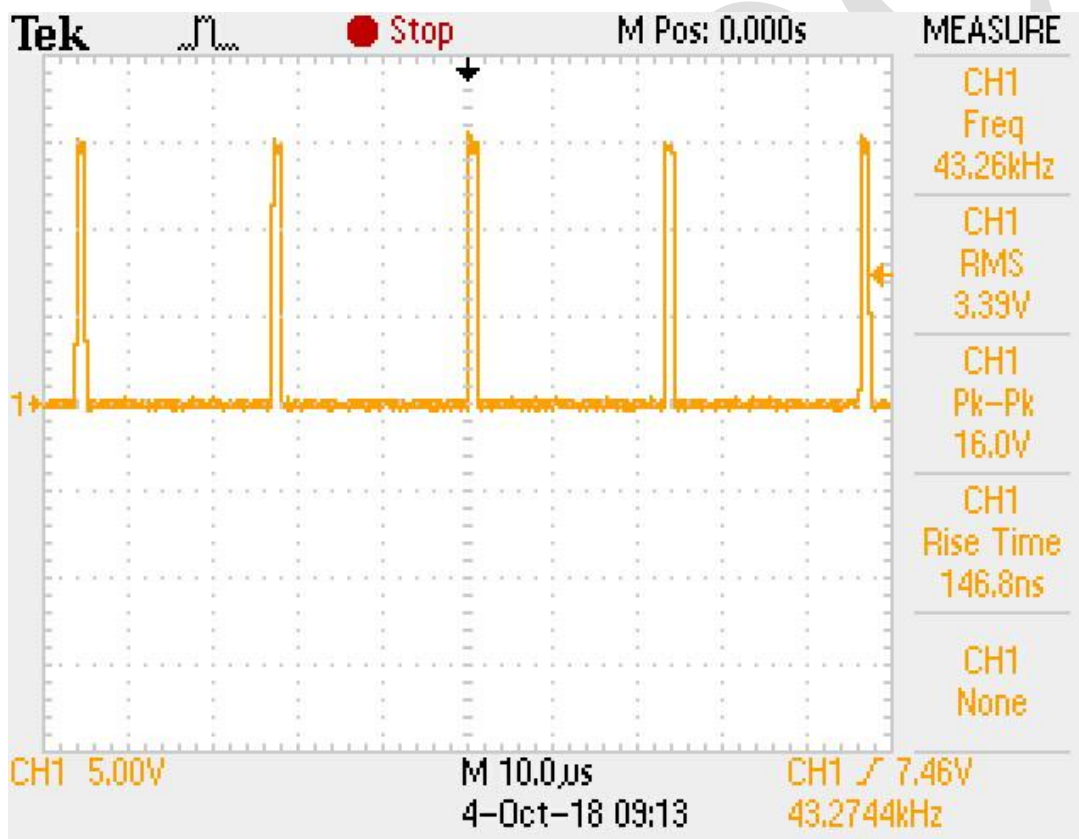
Figura 18, Sinal analisado no Gate com a fonte ligada à 180\text{Vrms} .
