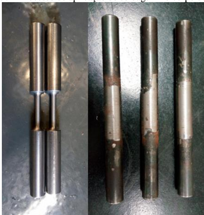
Figura 7 – Processo de aplicação de soldagem no corpo de prova
