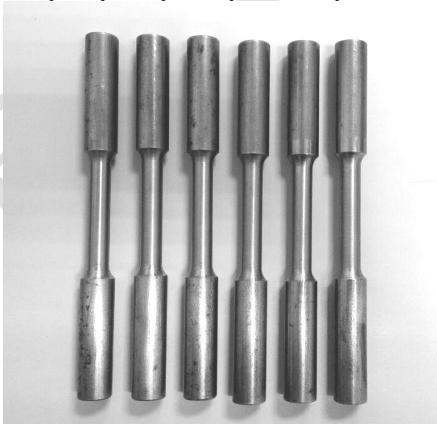
Figura 5 - Corpo de provas prontos para serem aplicado a metalização
