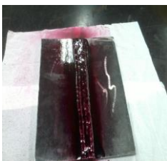
Figura 8(b)-Aplicação do líquido penetrante
