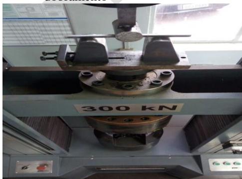
Figura 10 (a)- Ensaio de dobramento
