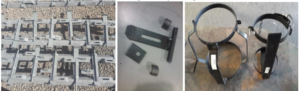
Figura 7 – Subprodutos fabricados com os retalhos (trinco ferrolho, peças para trinco e suporte bujão de gás).
