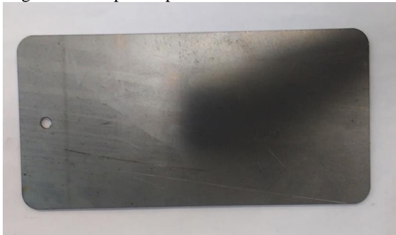
Figura 6 – Corpos de prova com cantos arredondados
