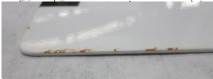
Figura 11 – Peças com início de corrosão após 386 horas no Salt spray
