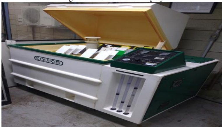
Figura 8 – Câmara de Salt Spray
