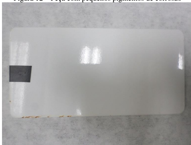
Figura 12 – Peça com pequenos pigmentos de corrosão
