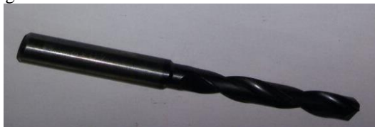
Figura 7 - Broca sem revestimento utilizada.
