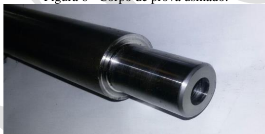
Figura 6 - Corpo de prova usinado.
