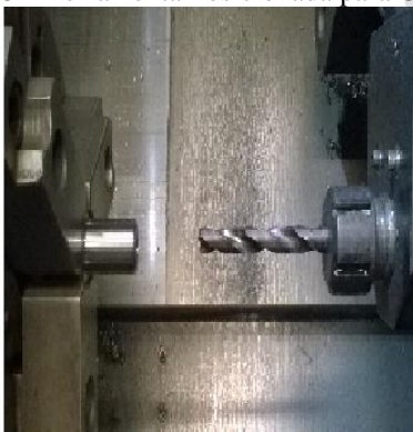
Figura 5 – Ferramenta Posicionada para Usinagem.
