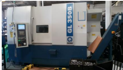
Figura 5 - Torno CNC Romi GL 350B.
