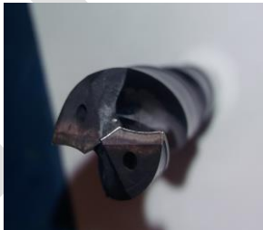
Figura 12 - Broca sem Revestimento Utilizada no Primeiro Lote.
