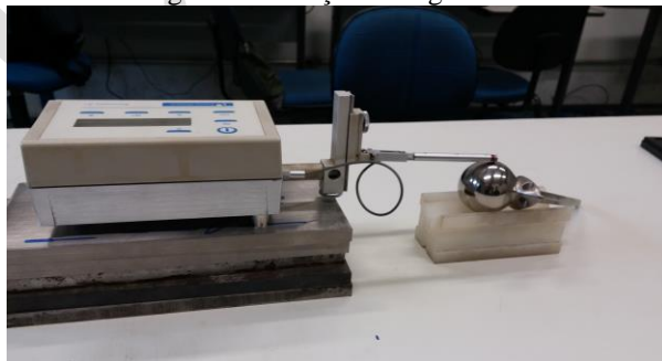
Figura 7: Medição da rugosidade
