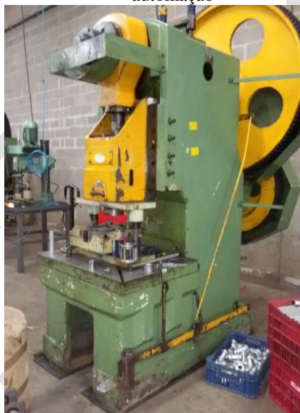
Figura 4: prensa excêntrica mecânica do projeto antes da automação
