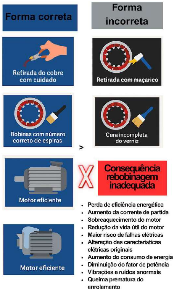
Figura 19 – Processo de rebobinagem correta e incorreta
