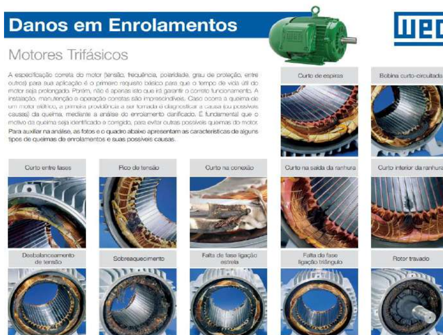
Figura 5 - Principais causas de queima de motores.
