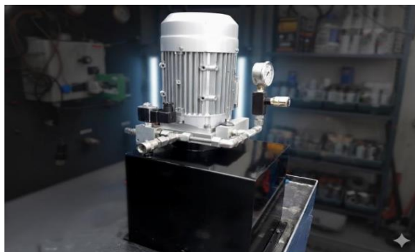
Figura 17 – Resultado final da unidade hidráulica
