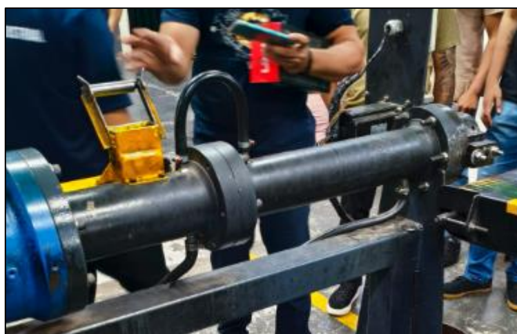
Figura 1: Extrusora mono rosca LD-12
