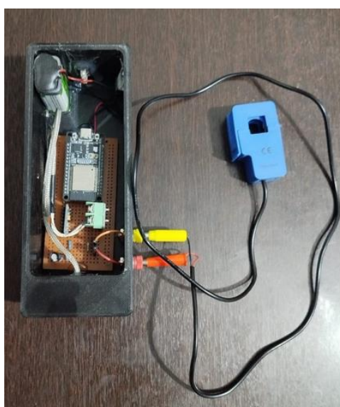
Figura 1: Protótipo do sistema de monitoramento acondicionado em case impressa em 3D
