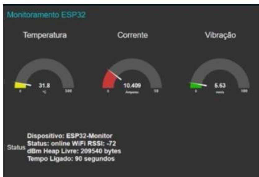
Figura 2: Dashboard de monitoramento desenvolvido na plataforma Node-RED
