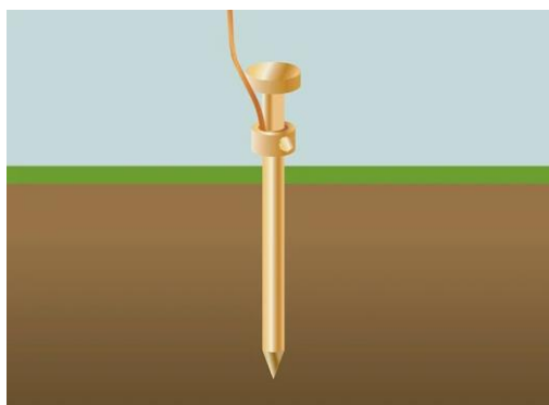
Figura 2 – Haste de Aterramento
