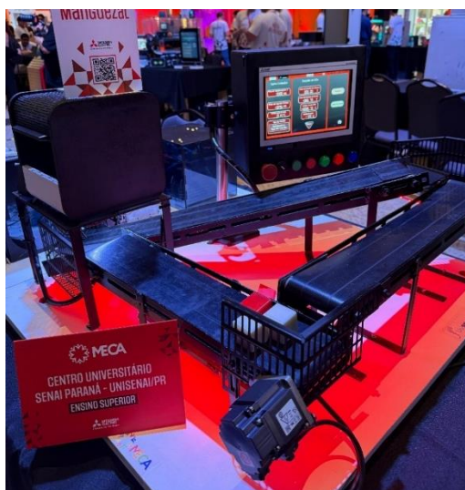
Figura 1 – Conjunto das três esteiras transportadoras que compõem o processo simulado
