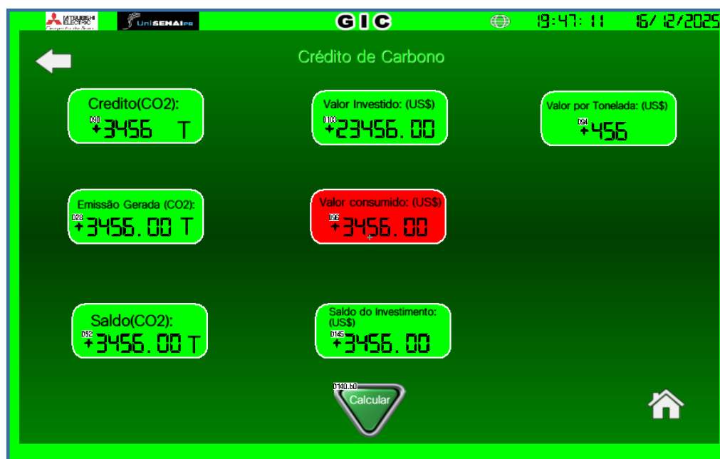
Figura 9 – Tela da interface homem-máquina para visualização das emissões estimadas e apoio à compra de créditos de carbono.
