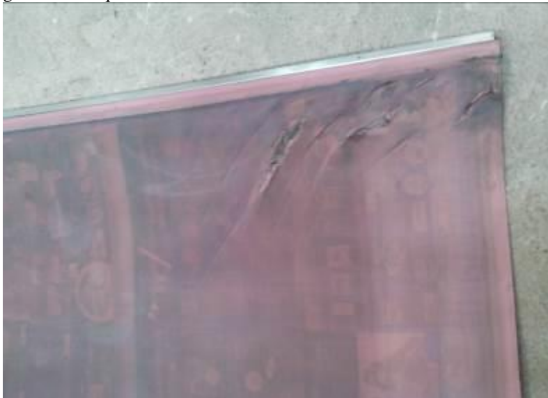
Figura 4 - Blanqueta com defeito de amassamento da camada de transferência
