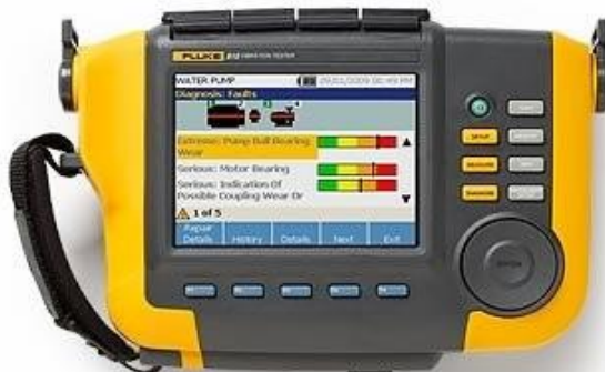
Figura 1 – Analisador de Vibração Fluke 810
